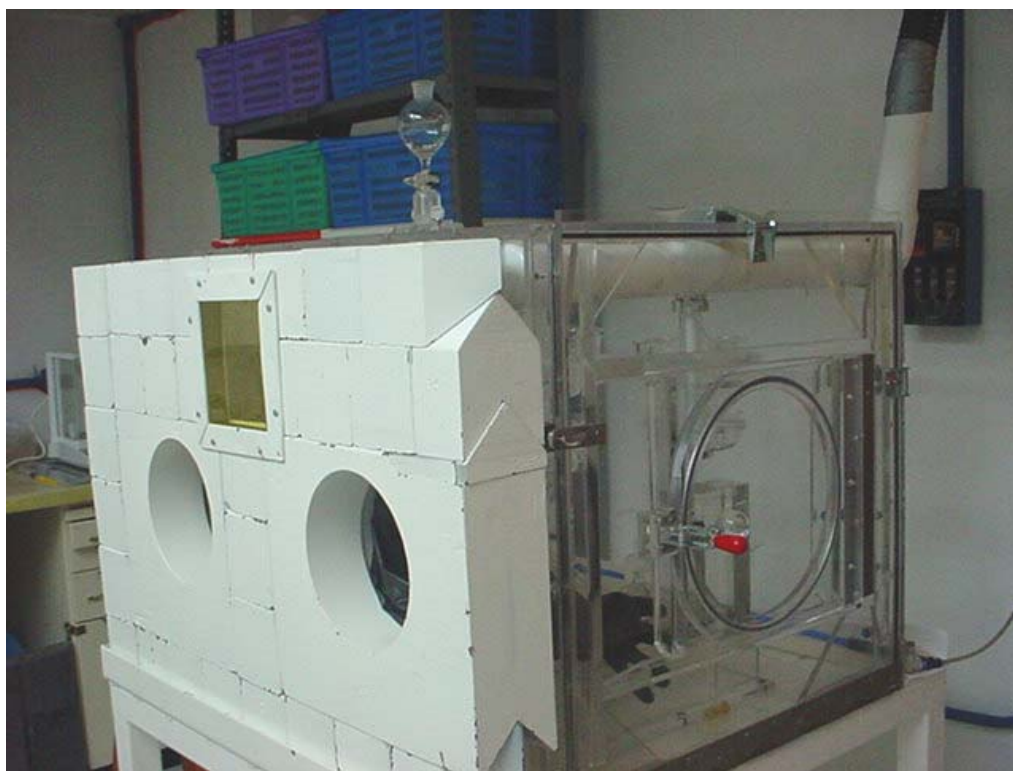
Figura 2. Celda de acrílico y barrera de protección de Plomo
